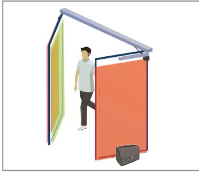
在检测区域内放置物体，以检查和确认安全区域的准确位置。
