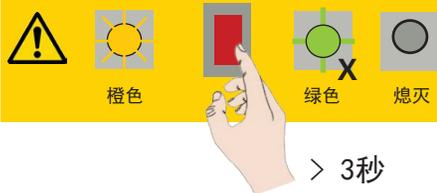
改变DIP开关设置后，橙色LED指示灯闪烁，长按按钮确认设置，闪烁的绿色指示灯的个数表示连接的模块个数。
