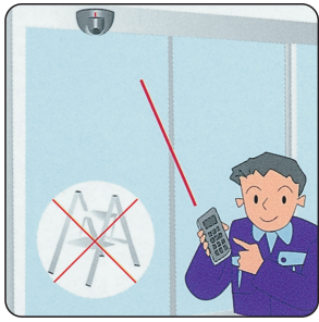
リモコンによるエリア等の調整が可能
