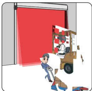
シャッター / ガレージドアの安全用センサーとして。開口部を面で覆い、対象物の「抜け」を防ぎます。
