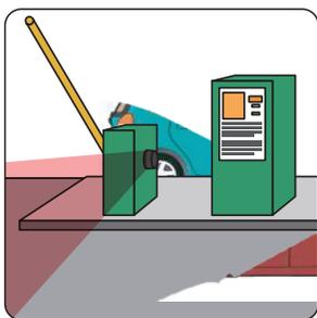
駐車場ゲートの安全用センサーとして。路面の影響を受けず、屋外で 사용할ことが出来ます。
