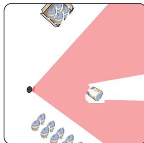
製造現場のロボット停止用センサーとして。小さなものも素早く検知し、信号を出力します。
