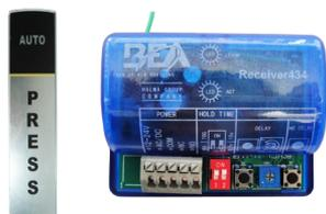
434MHz 无线按压开关以及无线接收器是一款实用，有效，外观精致的自动门手动开启传感器。
