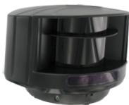
LZR<sup>®</sup>-I100 是基于飞行时间原理的激光扫描器，高精度的技术确保最佳的安全保护功能，具有4层动态激光扫描面，为车辆在道闸，出入口提供高级别的安全保护。
