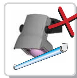
センサーの検知エリア内に蛍光灯など光源が入らない位置に設置して下さい。
