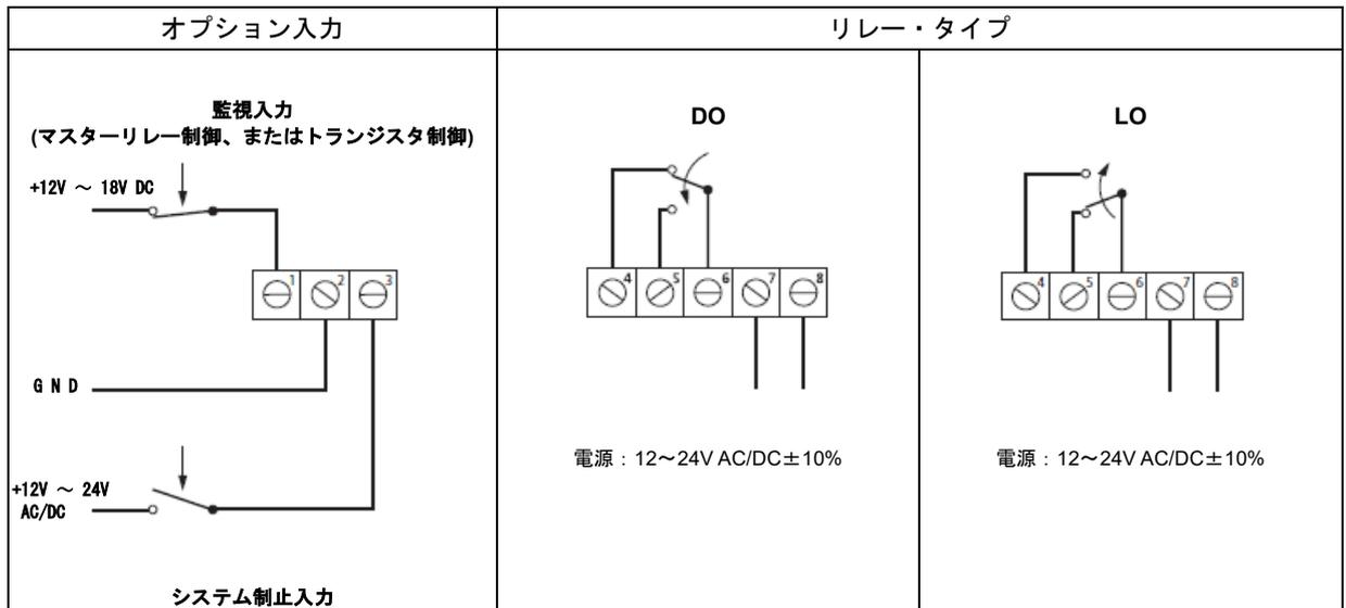
注意：オペレータのリレー端子に誘電負荷が接続されている場合は、ダイオードを取付け保護してください。
