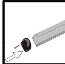
・ドアのちようつがい側になる部分に、側面カバーをネジ止めします
