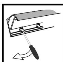
・スレーブモジュールをはずしてから、ネジ回しでモジュール取付け台をはずします
