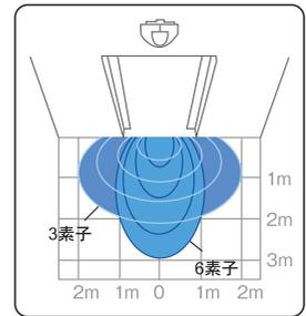
アンテナ軸方向角度 (-30° ~ 0° +30°)
