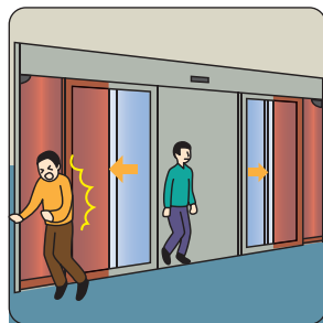
スライドドアの引き込み側安全対策
