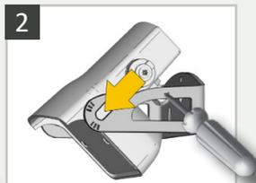
センサー角度を固定し、ビスで本体を固定して下さい。
