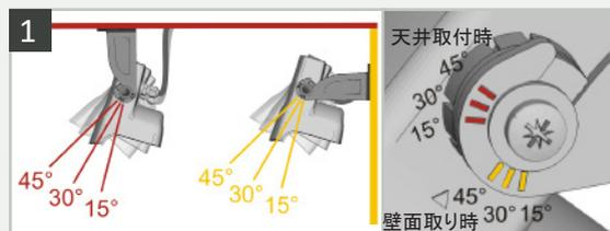
マイクロ波を照射したい向きに合わせ角度を調整して下さい。
