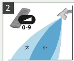
リモコンで検知エリアの大きさを調整して下さい。
