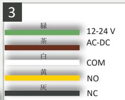
使用する信号回路をNOかNCかを決定し、ケーブルを接続して下さい。
