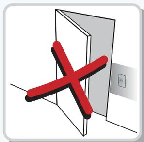
本機を金属製の壁や板の裏には設置しないで下さい。正常に検知できなくなる可能性があります。
