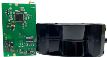
LZR<sup>®</sup> Raw-M420P 是一款 4 线激光测量扫描仪，采用高效的双向通信协议，广泛应用于站台屏蔽门 (PSD) 保护和 AGV 三维防撞等应用场景。
