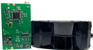
LZR<sup>®</sup> Raw-M420S 是一款 4 线激光测量扫描仪，具有高效的双向通信协议，广泛应用于站台屏蔽门 (PSD) 保护和 AGV 三维防撞等应用场景。
