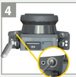
ブラケット背面の調整用ネジ2本でレーザーカバーの位置を合わせて、止めネジ2本でブラケットを固定してください。
