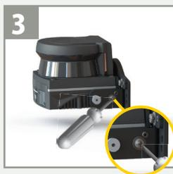
ブラケット側面の調整用ネジ2本で本機の傾斜角度を調整し、止めネジ2本でブラケットを本機に固定してください。
