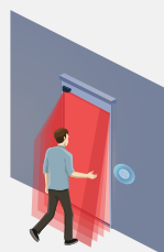
平开门保护：扩大关门时的安全区域
